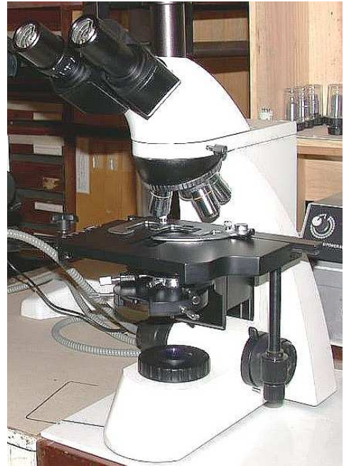
Photo 09 : microscope trinoculaire ARX3000 équipé d'un contraste de phase
