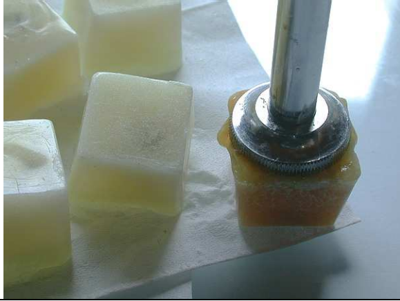
Fixation à chaud du bloc sur la tige de support du microtome
